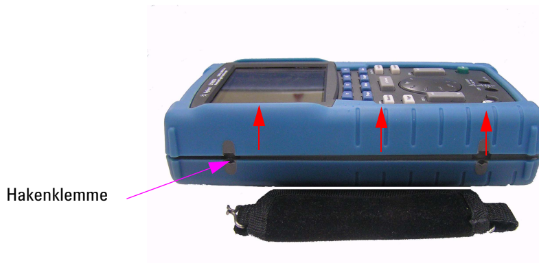
Abbildung 8-8 Die Handhalterung vom Instrument entfernen
