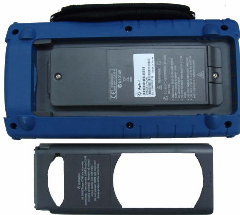
Abbildung 8-2 Demontieren Sie den Ständer vom Instrument
