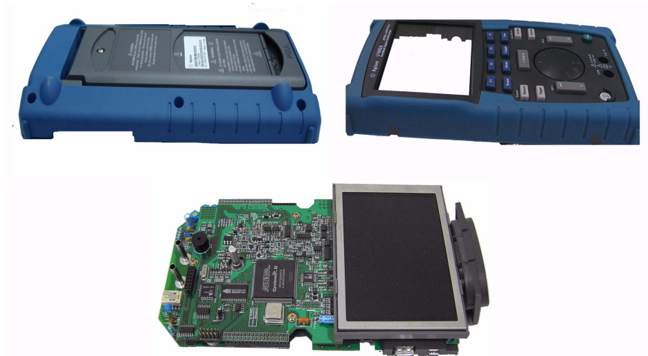
Abbildung 8-10 Entfernen Sie die vordere Ummantelung (rechts) und die hintere Ummantelung (links) von der Leiterplatte des Instruments
