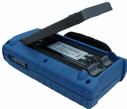
Abbildung 8-5 Entfernen Sie die Akkuabdeckung, ohne den Ständer zu entfernen
