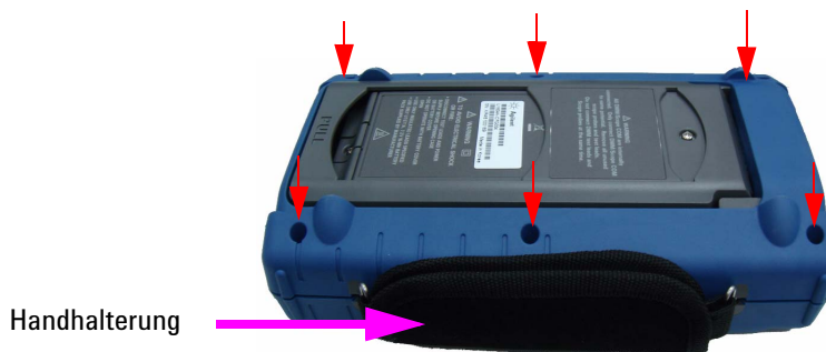
Abbildung 8-7 Entfernen Sie die Schrauben der hinteren Abdeckung
