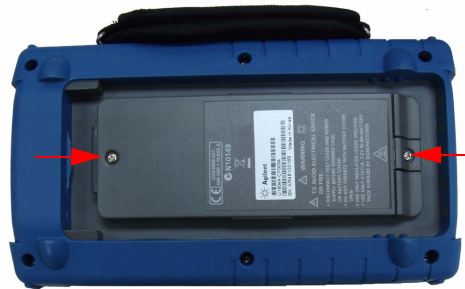
Abbildung 8-3 Entfernen Sie die Schraube der Akkuabdeckung
