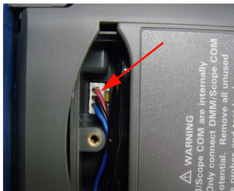
Abbildung 8-6 Entfernen Sie den 3-Draht-Stecker mit einer Pinzette.
