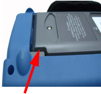
Abbildung 8-1 Drücken Sie in Richtung des Pfeils, um den Ständer zu entfernen
